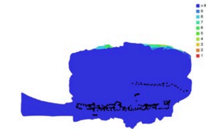
Fig. 1. Emplacements des caméras et chevauchement des images.
